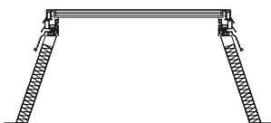
Kingspan ESSMANN Flachdachfenster mit 3-fach Wärmeschutzverglasung im Querschnitt
