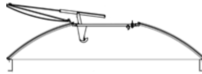
Firstklappe mit NRWG PN A/Z LB im Querschnitt
