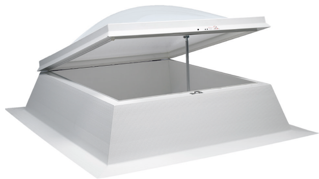
Lichtkuppel LK classic in PC-st Verglasung mit Aufsetzkranz AK PVC in 30 cm Höhe und Linearantrieb – Lüftungsposition
