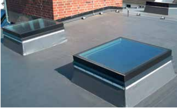
Flachdachfenster FDF neo plus mit thermisch getrenntem Aluminiumprofil RAL 9005 beschichtet und 3-fach Sonnenschutzverglasung
