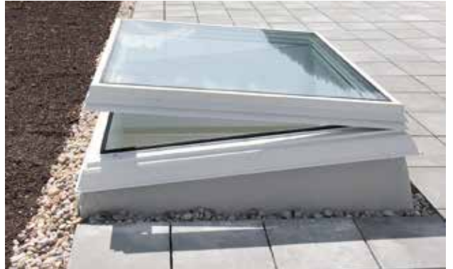
Flachdachfenster FDF mit thermisch getrenntem Stahl-Aufsetzkranz AK ST-TG Flex 6° – Lüftungsposition
