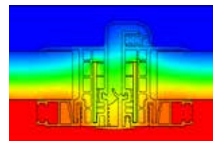
Isothermenverlauf AirFlip Lamellen- stoßbereich SLB im Schnitt
